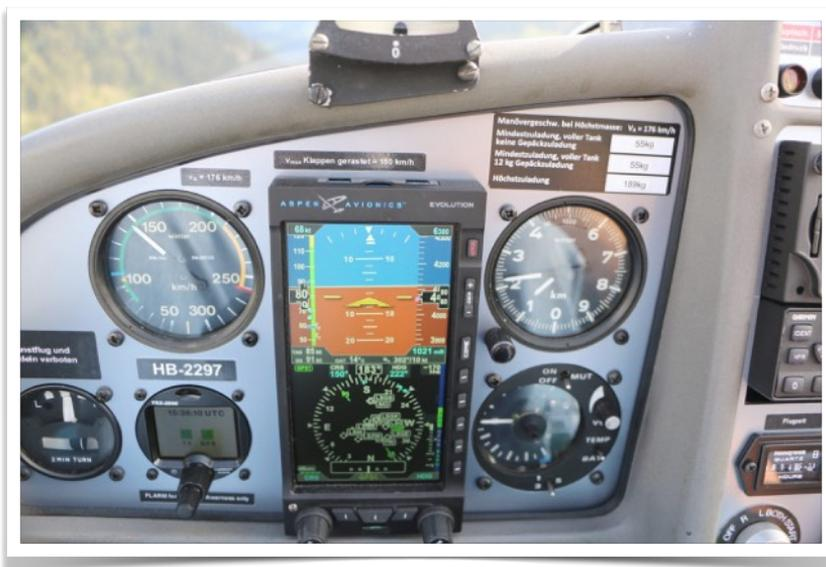
*Die Super Dimona HK-36 verfügt sowohl über digitale (imperiale) wie auch analoge (metrische) Instrumente*
