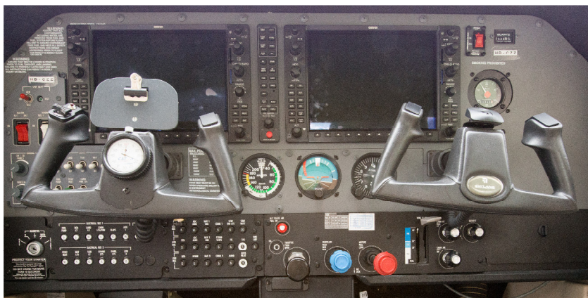
Cockpit der Cessna 182T mit G1000 und GFC 700 (Autopilot)
