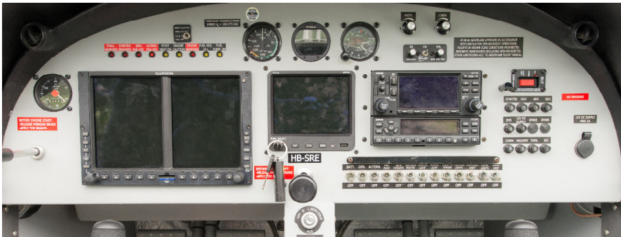
Cockpit der neuen AT3 mit G500 und MPV 50
